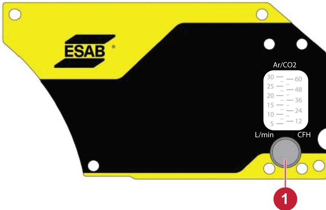
1. Perilla para ajustar el caudal de gas (solo para variantes de productos que contengan un medidor de caudal de gas)
